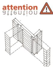
**!** Intégrer la vêtture en préfabrication ? Si les maîtres d'œuvre souhaitent ouvrir aux entreprises cette possibilité, ils doivent élaborer un calepinage de bardage qui permettra de gérer les raccords entre panneaux, en horizontal, en vertical et au droit des angles. Une solution peut être un calepin avec un retrait de 15 cm du bardage de part et d'autre du point de jonction, ce qui permettra de refaire la continuité du pare-pluie et sera terminé avec un panneau de bardage préfabriqué.
