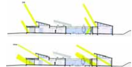
▲ Orientées au sud, les baies vitrées jouent le rôle de capteurs solaires en hiver et sont protégées du rayonnement direct l'été par des avancées de toiture.
